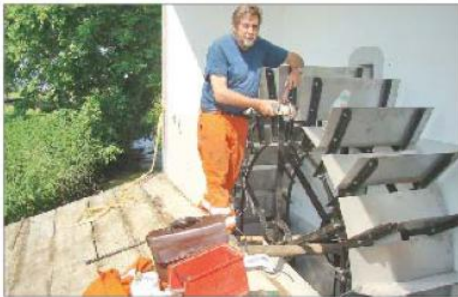
Werner Holzer aus Bätterkinden hat gemeinsam mit Kollegen für ein Kleinwasserkraftwerk in Utzenstorf ein originalgetreues Schaufelrad gebaut. Albert Ullmann
